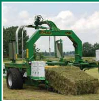
Chargement rapide des balles par convoyeur
