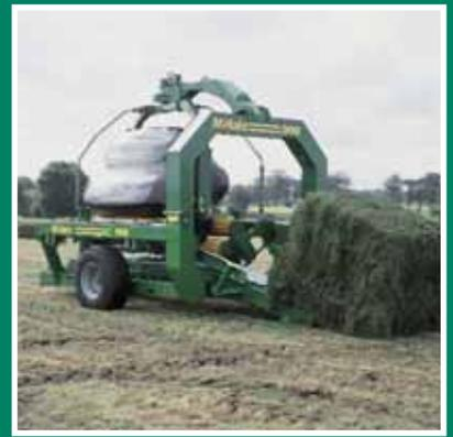
Chargement et enrubannage d'une double balle en simultané
